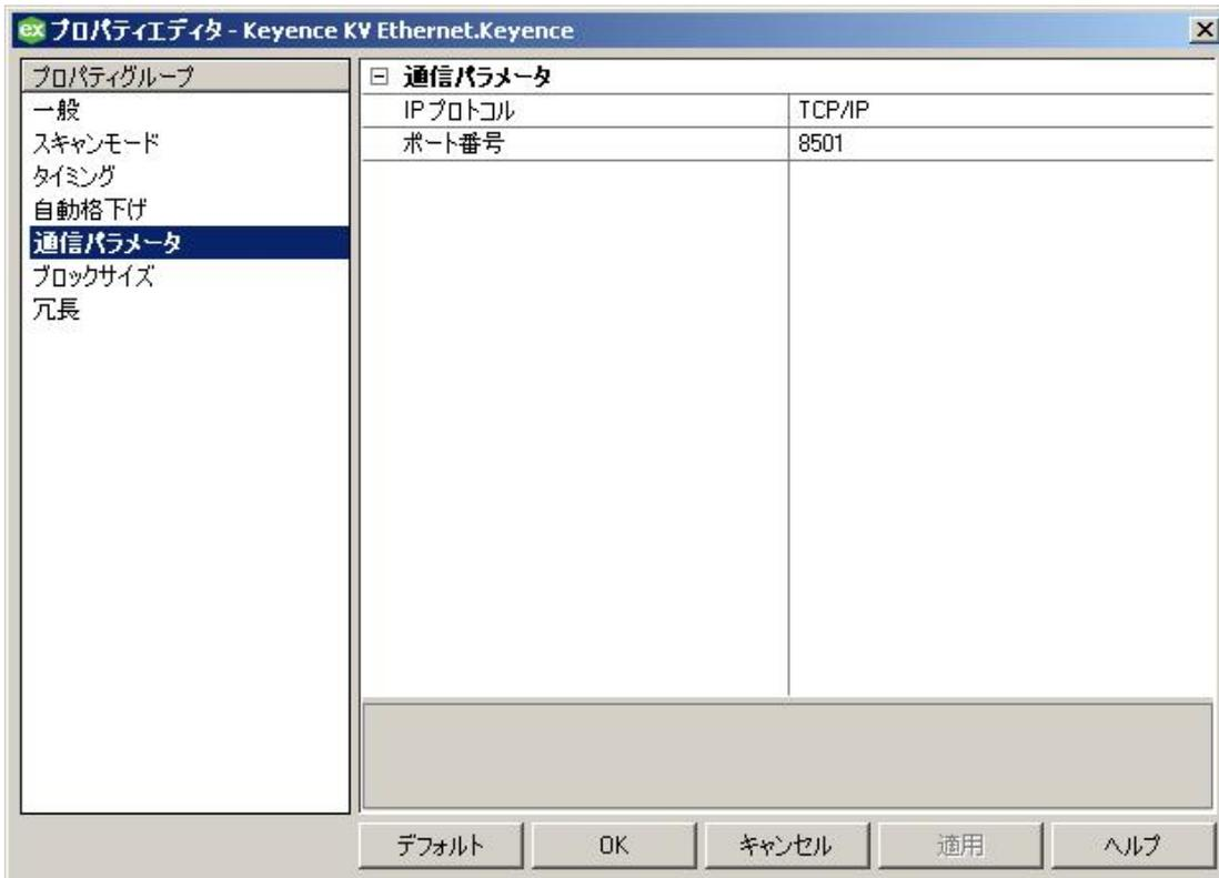
「IPプロトコル」: TCP/IP または UDP 通信を選択します。この選択は使用されているターミナルサーバーの特性によります。デフォルトのプロトコル選択は TCP/IP です。
